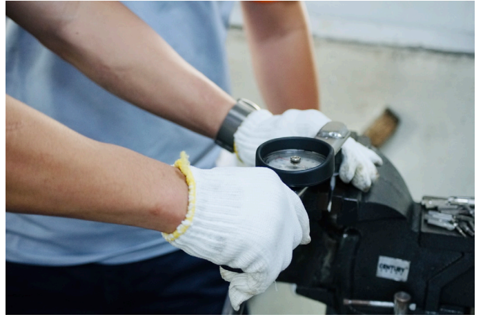
Máy kiểm tra độ xoắn: Dùng để kiểm tra lực siết khi lắp ốc vít.
