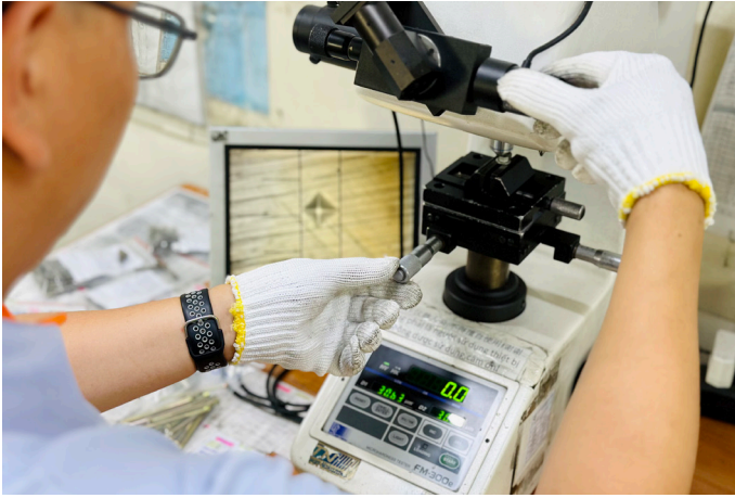
Máy kiểm tra độ cứng: Đo độ cứng của bề mặt và vật liệu lõi của ốc vít
