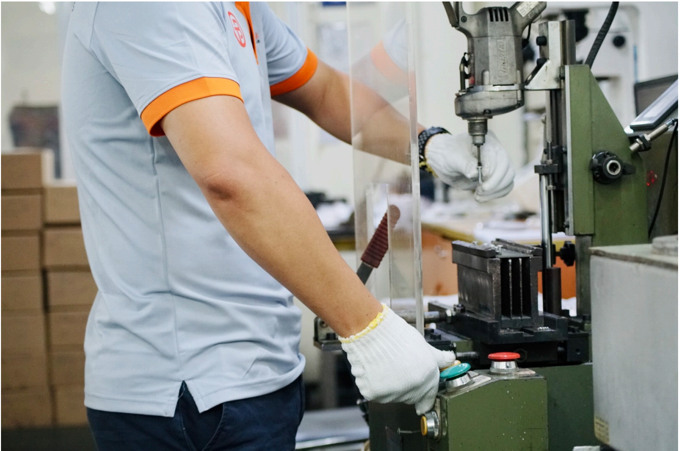
Máy kiểm tra thời gian khoan: Đo thời gian khoan xuyên bề mặt vật liệu cần liên kết của ốc vít.
